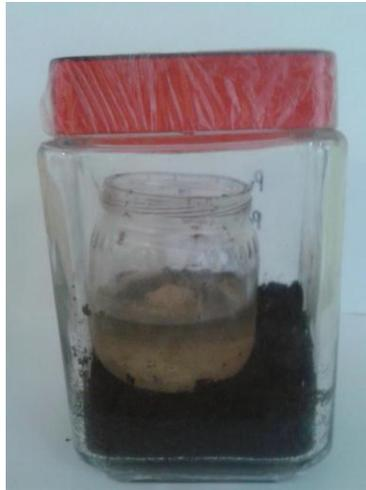
Figura 11. Montaje del relleno sanitario y la trampa de CO<sub>2</sub>
