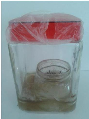
Figura 12. Montaje del agua de lago y la trampa de CO<sub>2</sub>
