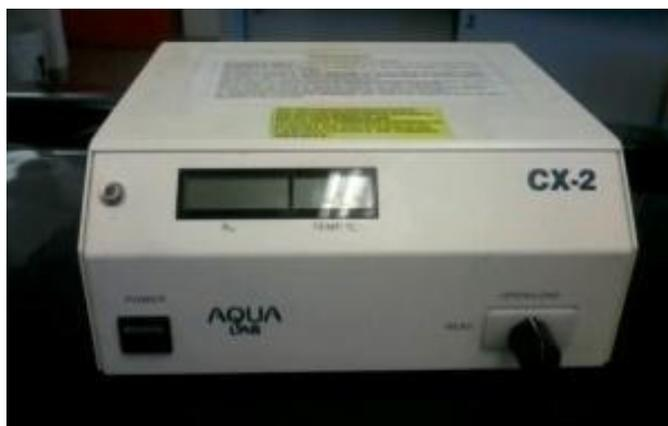
Figura 9. Higrómetro marca AQUALAB
