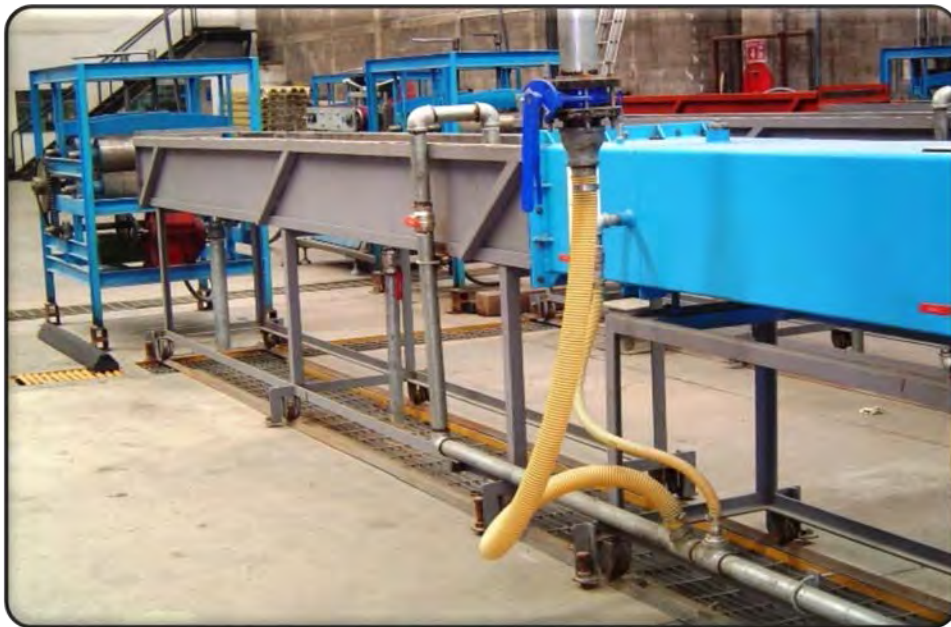
Fig. 3.8. Vista lateral de la conexión entre el formador y la tina de enfriamiento.
