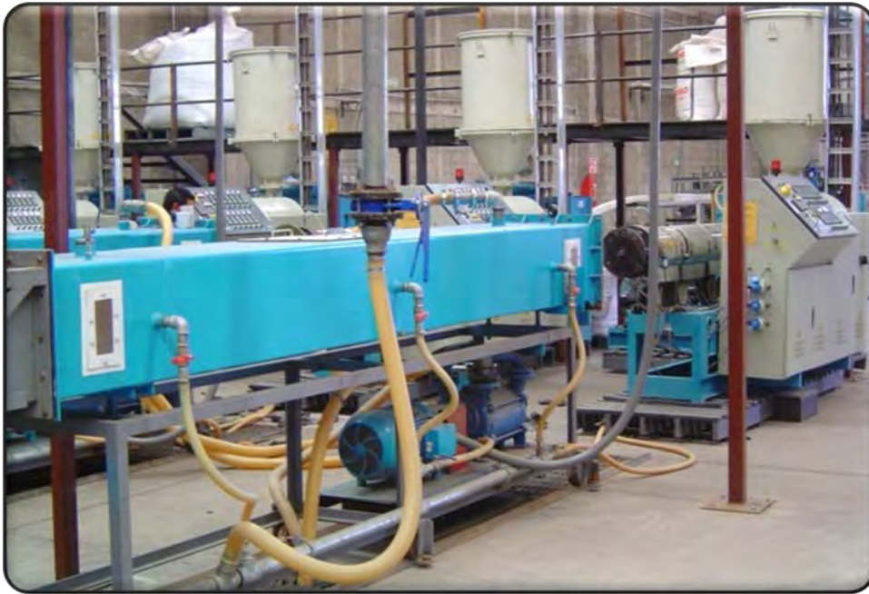
Fig. 3.7. Vista lateral de la cámara contenedora del formador o dado.
