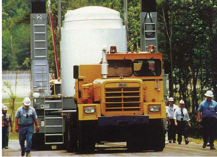
Figura 4-5. Transportación de contenedor de almacenamiento de tipo vertical
