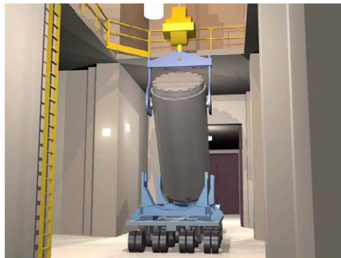
Figura 4-7. Levantamiento del contenedor de transferencia del tráiler
