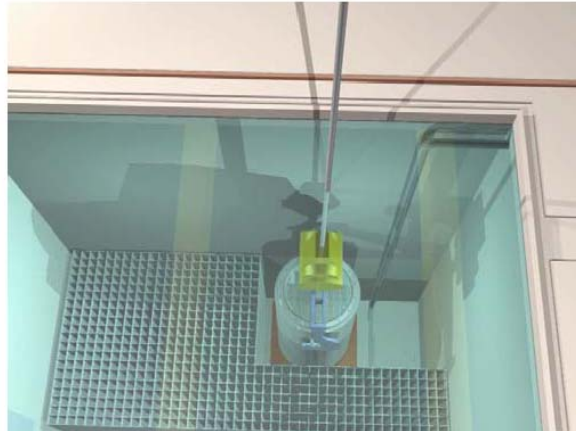
Figura 4-10. Contenedor de transferencia/contenedor metálico dentro de la alberca
