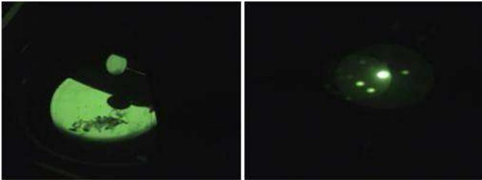
Figura 17 y 18. Observación de nanoplacas (izquierda) y patrón de difracción de electrones (derecha)
