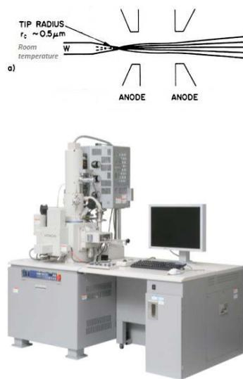
Figura 14a. Microscopio Electrónico de Barrido de Emisión de Campo de Cátodo Frío (“Cold FE”) de ultra alta resolución marca Hitachi SU8030. El cañón de electrones tiene un cátodo funcionando a temperatura ambiente.
