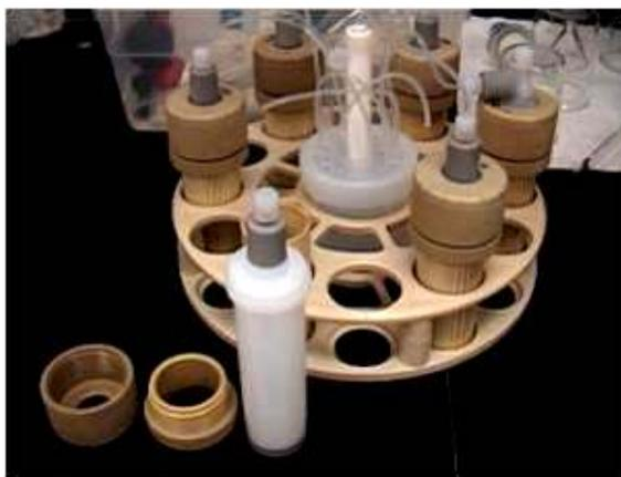
Figura 9: Vaso de Teflón (junto al carrusel)
