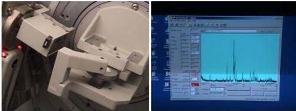
Figura 22 y 23. Salida de Rayos X y portamuestra (izquierda) y difractograma visto en el monitor del equipo (derecha)
