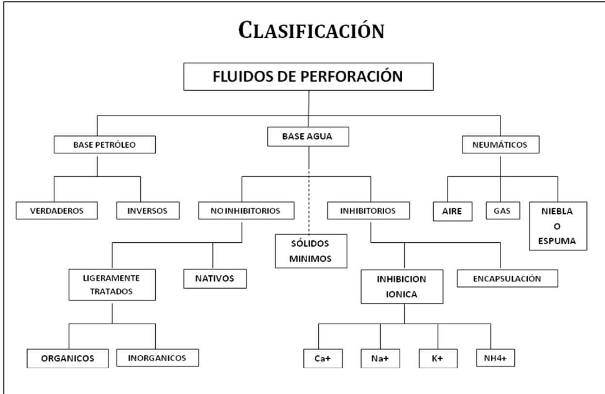
Figura 3. Clasificación de los fluidos de perforación de acuerdo a su fase continua.
