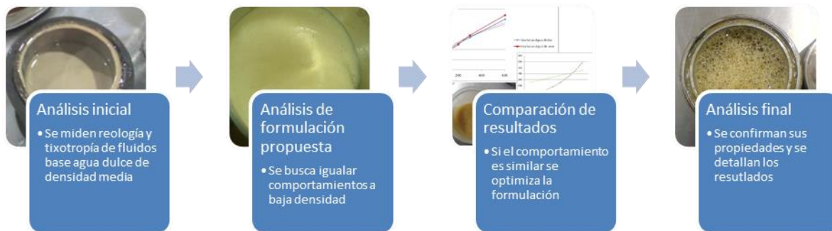
Fig. 5. Esquema general del procedimiento en busca de la formulación óptima.
