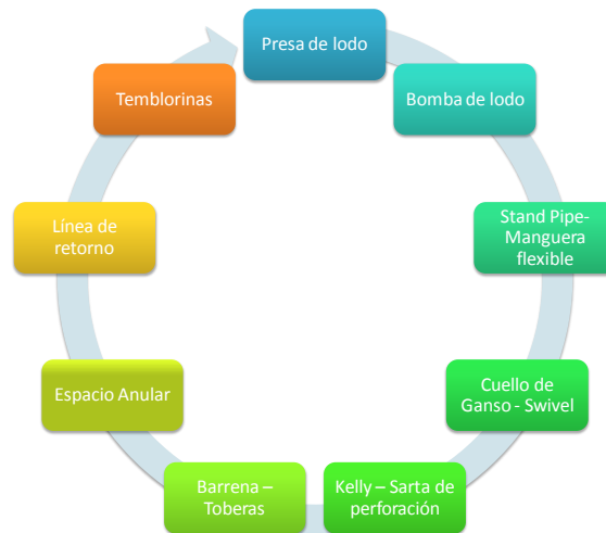
Figura 1. Diagrama general del sistema circulatorio durante la perforación.
