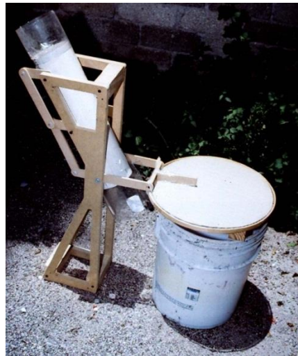
Figura 84 Modelo funcional a escala real del sistema de descarga de mezcla secante.
