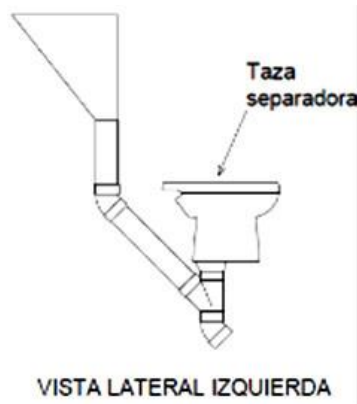
Figura 66 Redirección mediante tubos y conexiones pvc.
