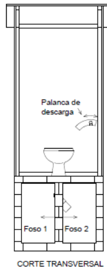
Figura 65 Instalaciones fijas y al centro del piso del baño.
