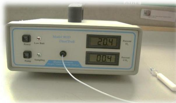
Figura 7. Analizador de  $O_2$ - $CO_2$  Quantex Instruments 905, U.S.A.
