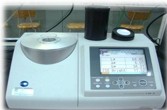
Figura 8. Espectrofotómetro de mesa Kónica Minolta CM-5, Japón.
