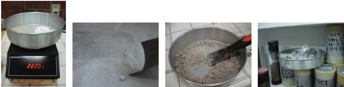
Figura 3.6: Proceso para preparar el material, previo a la compactación
