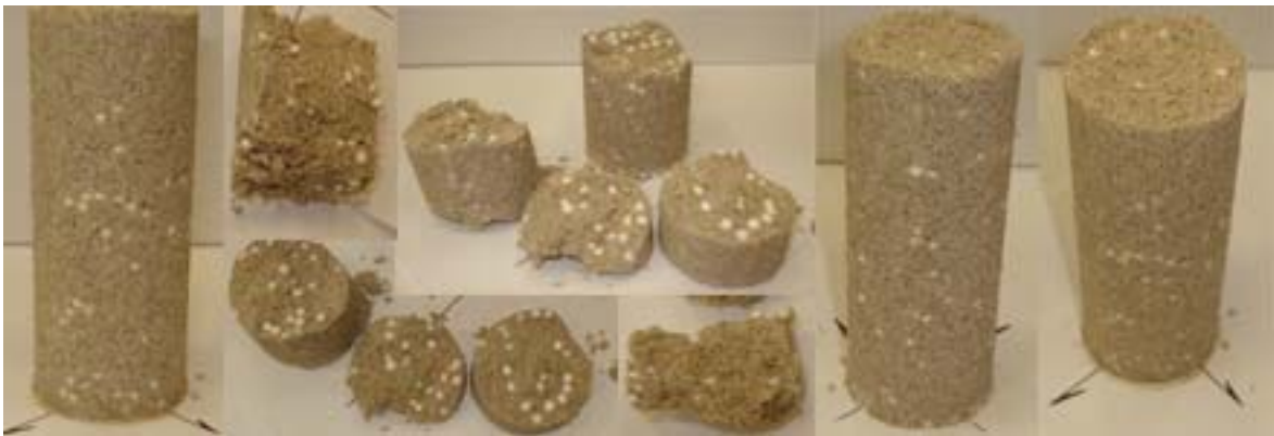
Figura 3.13: Vista del espécimen de una mezcla de suelo con 25 % de perlas de EPS, en volumen y un contenido de agua de 9 %
