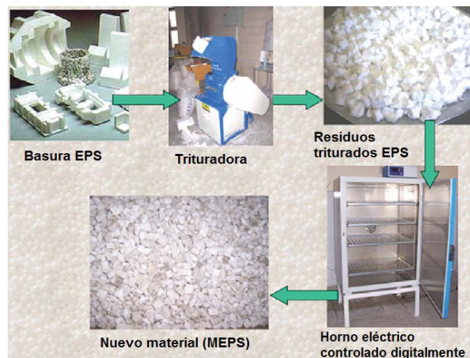
Figura 2.8: Descripción del proceso de modificación de residuos de EPS [35]
