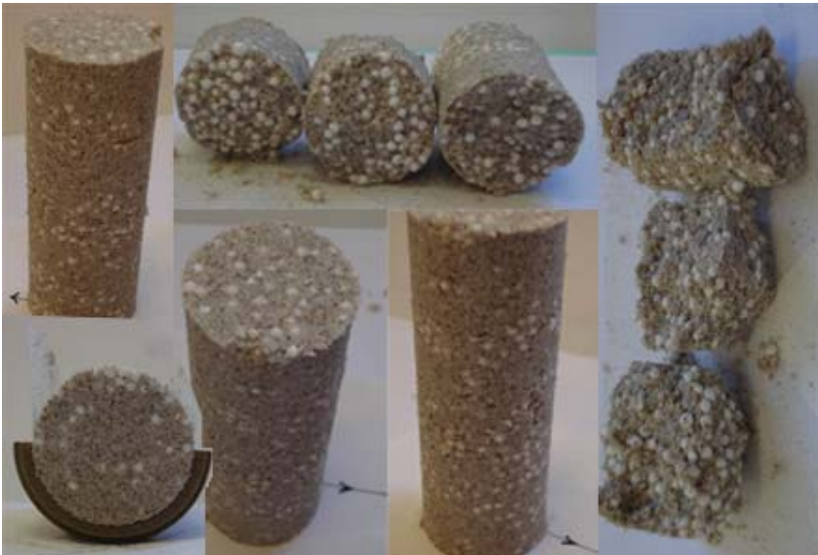
Figura 3.16: Vista del espécimen de una mezcla de suelo con 75 % de perlas de EPS, en volumen y un contenido de agua de 11 %
