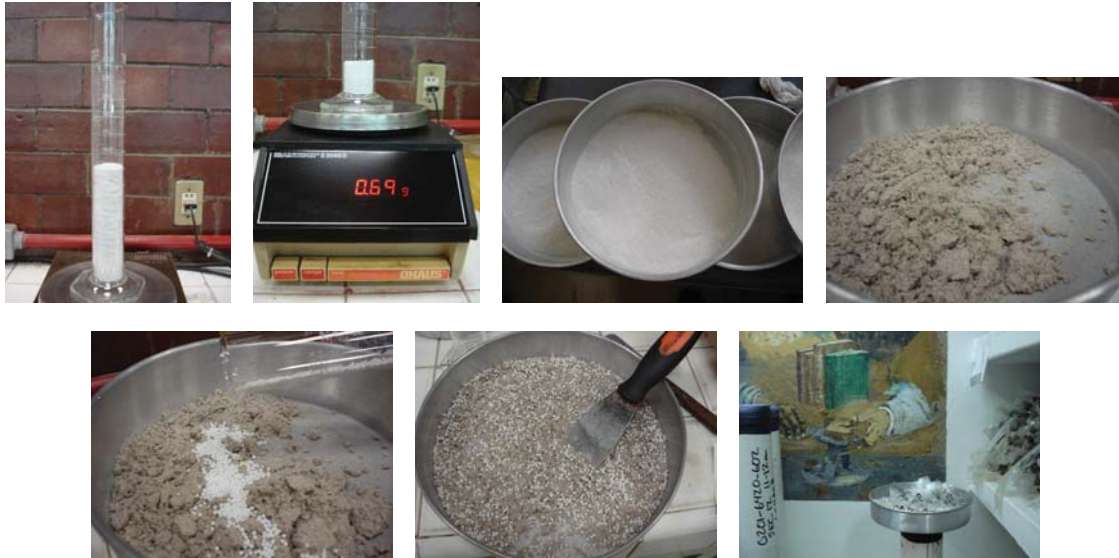
Figura 3.9: Proceso para preparar la mezcla suelo-perlas de EPS previo a la compactación
