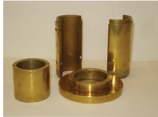
(b) Vista del molde desarmado
