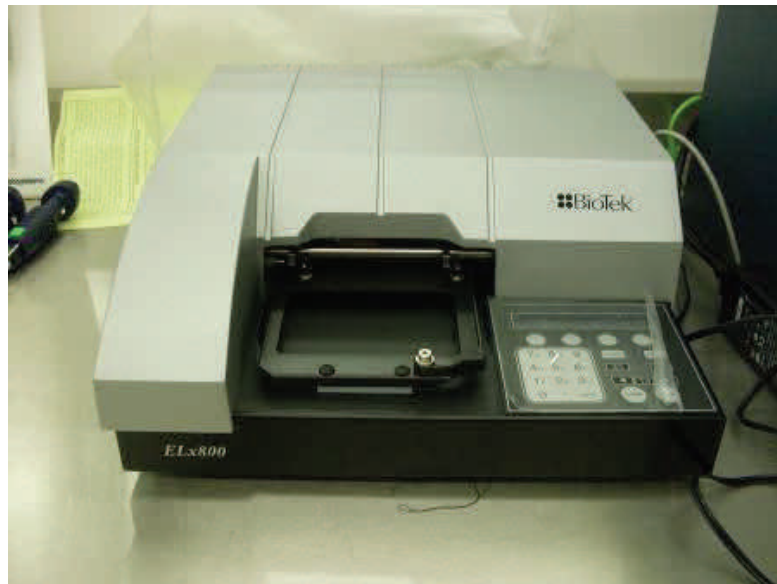
Figura 61. Lector de ELISA. Espectrofotómetro donde se realiza la lectura de la prueba.
