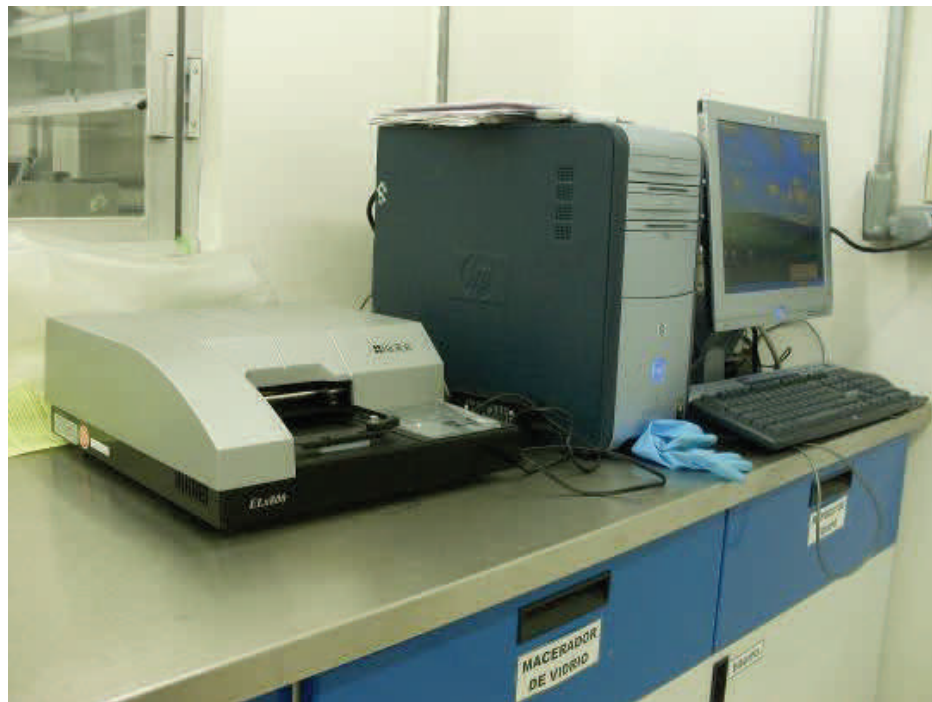
Figura 63. Lector de ELISA conectado a una computadora. Los resultados son expresados en Densidades ópticas, los cuales son arrojados en una base de datos con la utilización de un software.
