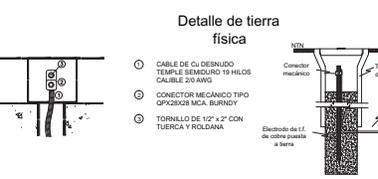
1. CABLE DE CUBIENSO TIPO S&MQUID 19 HLOS CALIBRE 20 AWG
