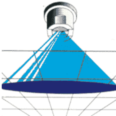
Figura 3.4 Representación esquemática del perfil de distribución de aire producido por la boquilla tipo abanico [17].
