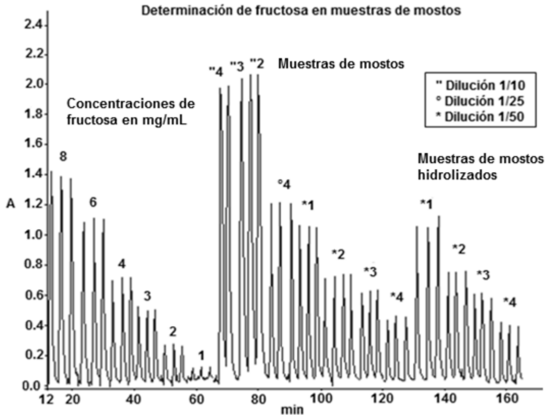
Figura 3.14. Diagrama obtenido de inyectar disoluciones estándar fructosa ( 8, 6, 4, 3, 2 y 1 mg/mL) y las muestras de mostos (1, 2, 3 y 4), en la configuración FIA para la determinación de azúcares reductores con DNS. Se utilizó como reactivo al DNS en medio alcalino. Se registró la señal en el detector a \lambda=480 nm.
