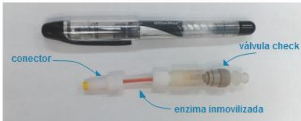
Figura 3.8. En la parte inferior de la figura se muestra el reactor empacado con la enzima glucosa oxidasa inmovilizada. En la parte superior de la imagen se colocó una pluma con el fin de mostrar las dimensiones del reactor enzimático.
