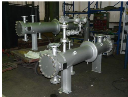
Figura 10 Condensador de vapor 19
