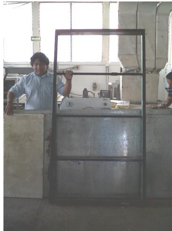
Figura 4.3 Estructura metálica del colector
