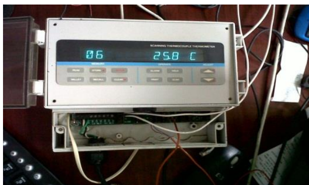
Fig.4.8 Termómetro de termopares multicanal
