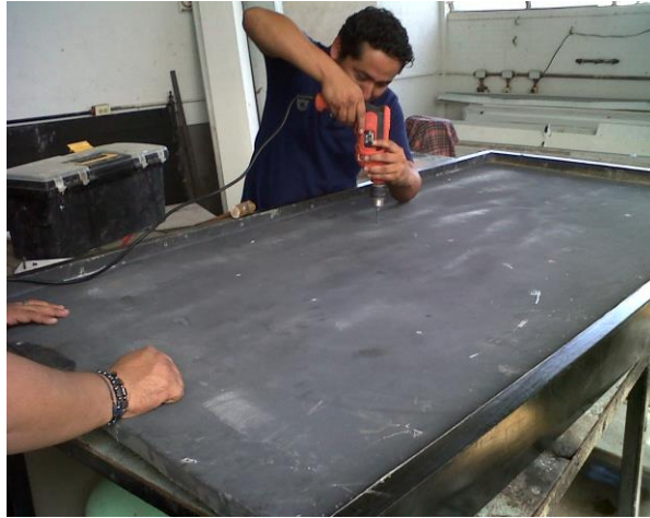
Fig. 4.4 Construcción de los colectores/regeneradores
