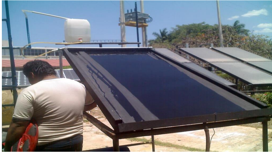
Fig. 4.14 Formación de la película descendente de desecante usando cloruro de calcio
