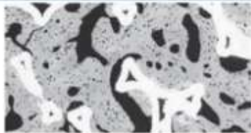
Figura 1. Micrografía que muestra la matriz de los espacios vacíos del tantalio cubierto de hueso 8 semanas después de la cirugía del fémur en perros. Imagen cedida por Zimmer.
