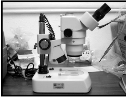
Figura 40. Microscopio estereoscópico de 40 aumentos marca National serie CAT.- LC3495C, empelado para los análisis en bajos aumentos.
