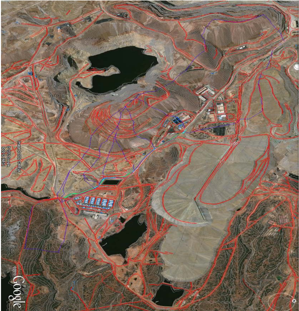
Figura 2.2-Sobreposición de la topografía al modelo digital del Google Earth.
