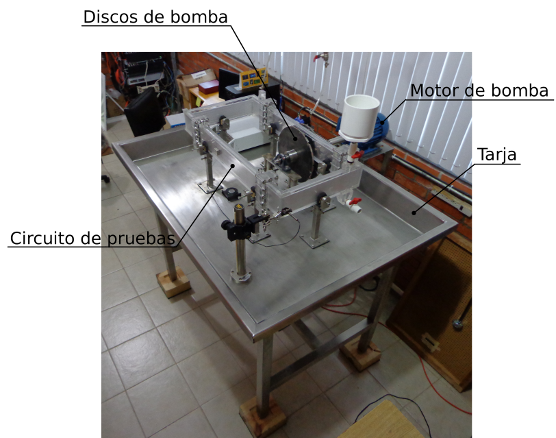
Fig. 3.17: Dispositivo experimental construido.
