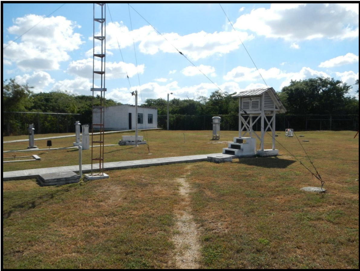
Figura 4.4 Garita meteorológica e instrumentos para medir la precipitación y el viento.
