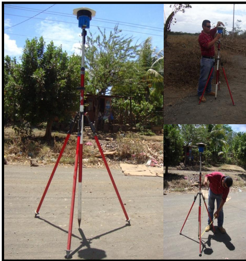
Figura 5.10. GPS-Diferencial sobre una de las estaciones geofísicas.
