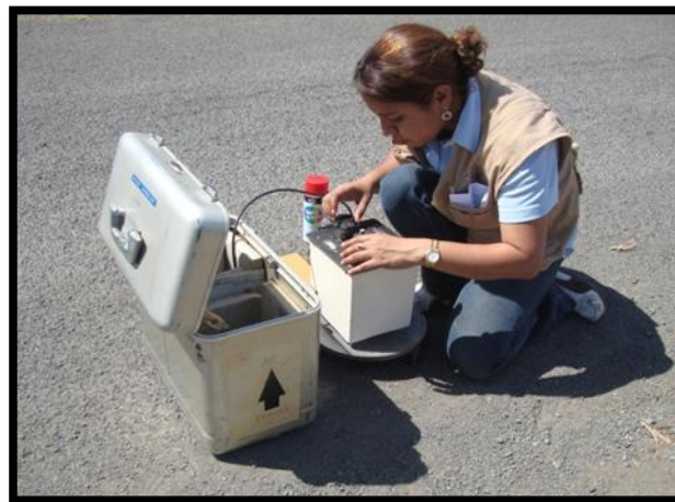
Figura 5.4. Mediciones de campo con el Gravímetro Lacoste & Romberg model G.
