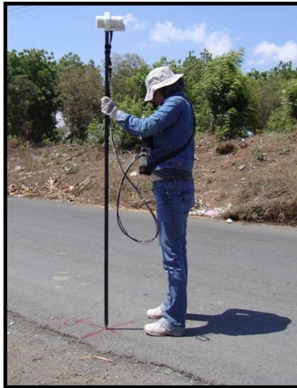
Figura 5.6. Operación de Campo con el magnetómetro GSM-19.
