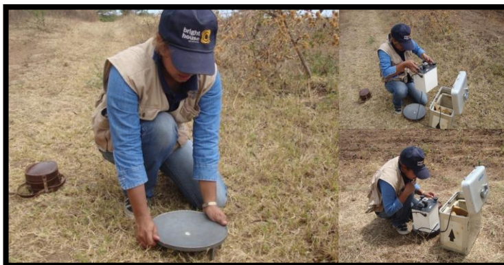
Figura 5.5. Nivelación del Gravímetro Lacoste and Romberg, para adquirir una lectura.
