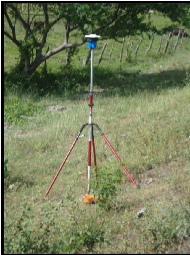
Figura 5.8. GPS-Diferencial sobre base geodésica (2952-II-4 BM).
