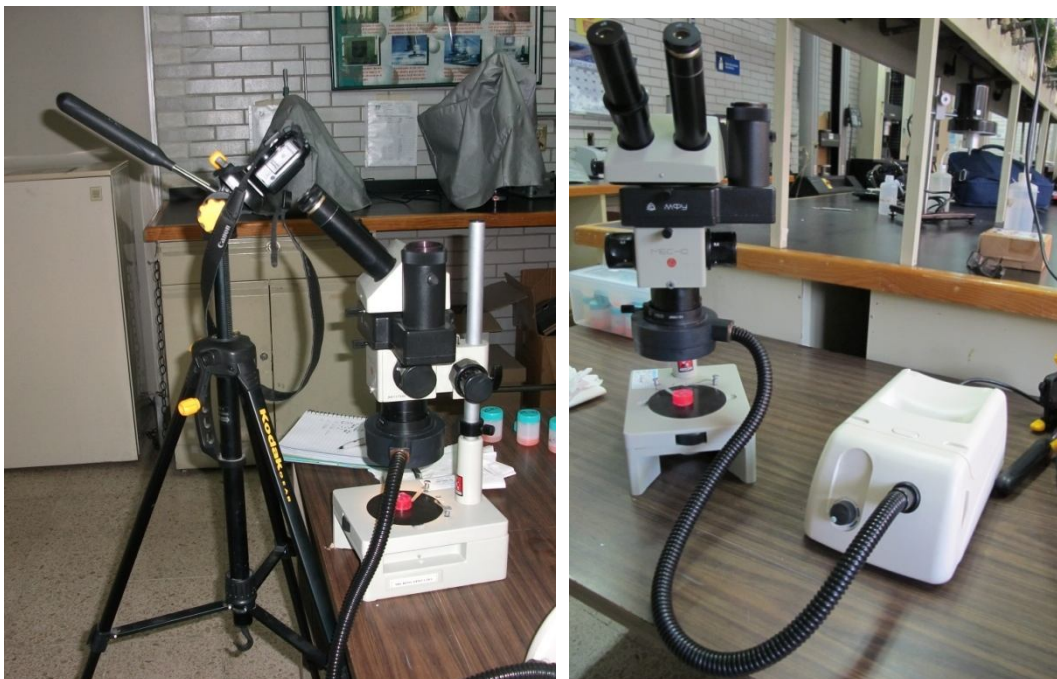
Fig. 8 Montaje del tripié en el microscopio óptico para observación de las muestras
