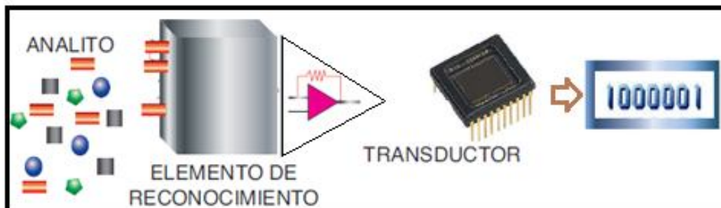
Figura 3: Esquema general del funcionamiento de un sensor.
