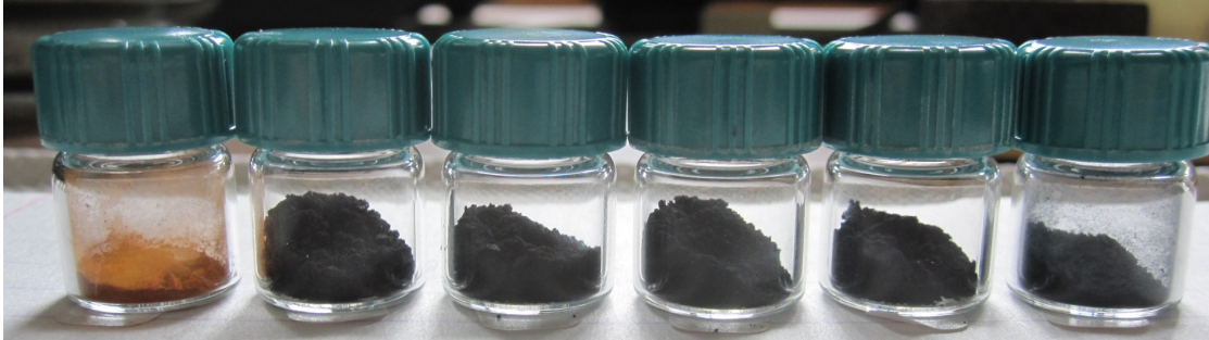
6.1 Cerámicos obtenidos \text{YbFe}_{1-x}\text{Mn}_x\text{O}_3 mediante la reacción en estado sólido, de izquierda a derecha composiciones x = 0.0, 0.2, 0.4, 0.6, 0.8 y 1.0 .
