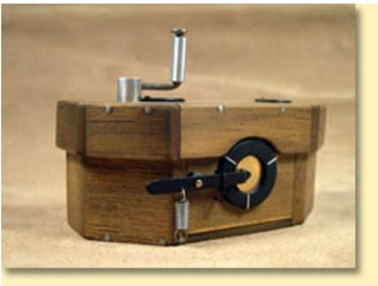
Esta otra, es una cámara de madera con sistema de fuelle a manera de disparador y una manivela para recorrer el rollo.
