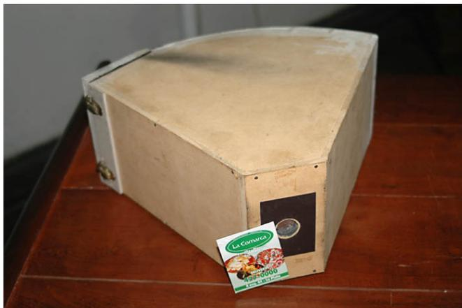
Esta cámara, es de construcción casera a manera de telefoto, con fondo curvado. Su constructor, para cubrir el estenopo, colocó dos imanes de propaganda para refrigerador.
