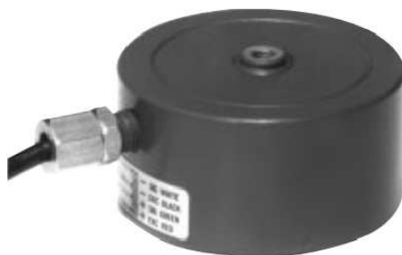
Figura 2.8: Celda de carga Lebow, modelo 3176
