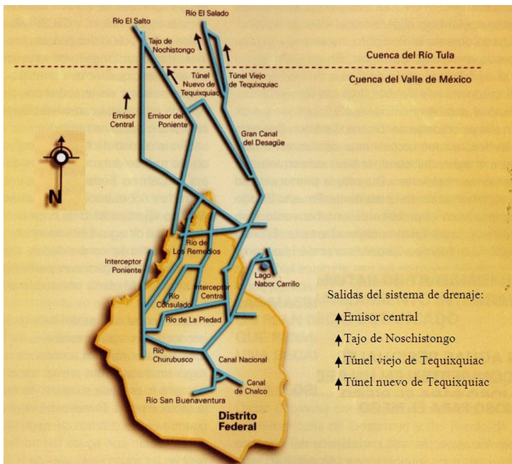
Figura 2.1 Salidas del drenaje profundo de la Ciudad de México.
