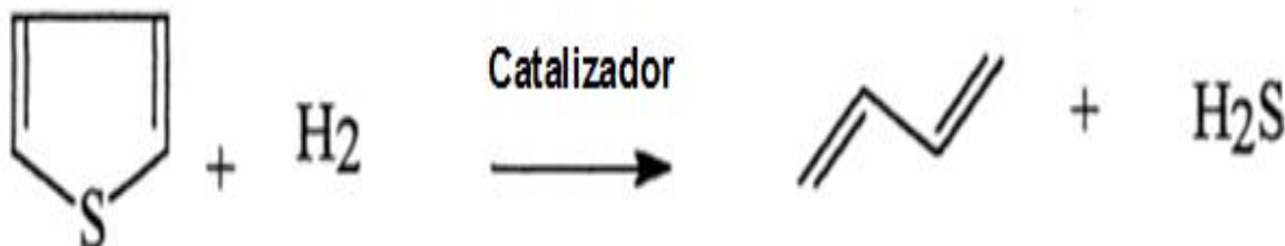
Figura 2.1. Esquema de reacción de HDS para la molécula tiofeno.
