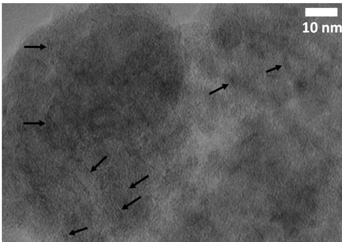
Figura 5.25. Micrografía de HRTEM para el catalizador NiMoW.
