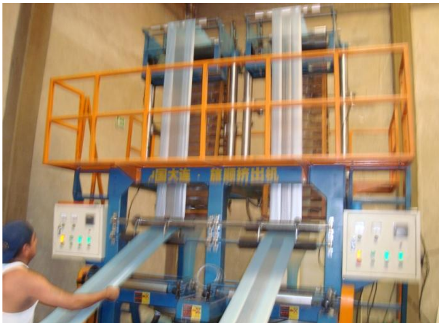
Imagen 4.6 Obtención del primer tiraje sin moldear
