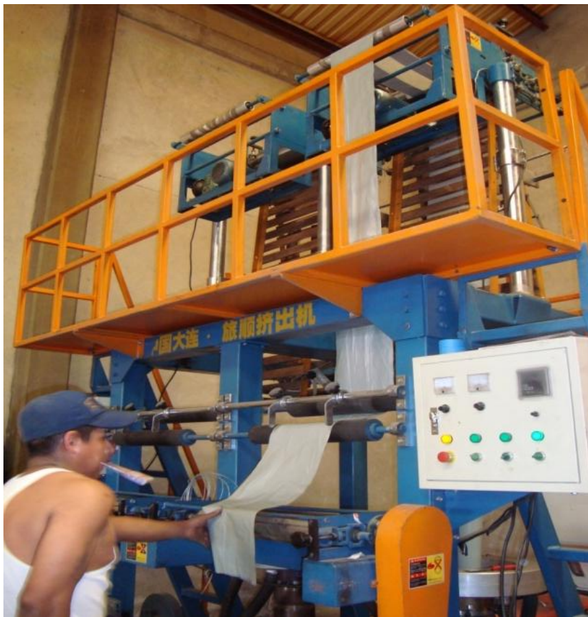
Imagen 4.5 Acomodo de tiraje de plástico sin moldear
