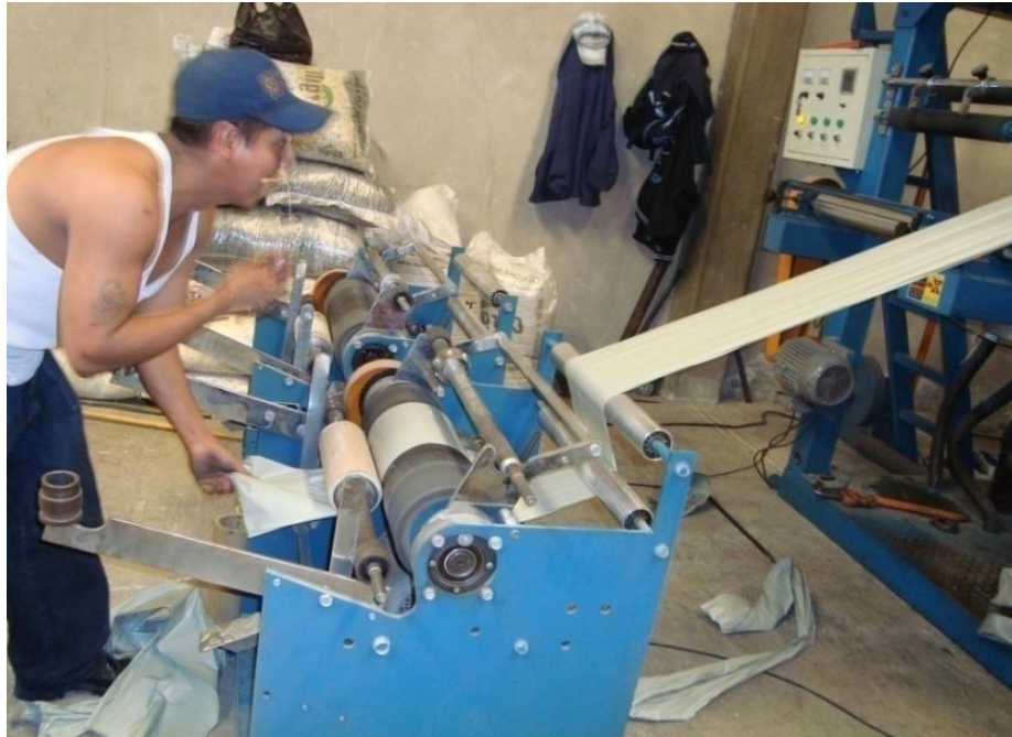
Imagen 4.7 Moldeo de la bolsa
