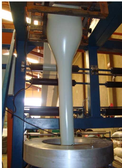
Imagen 4.3 Película formada a partir de la fundición de los gránulos.
