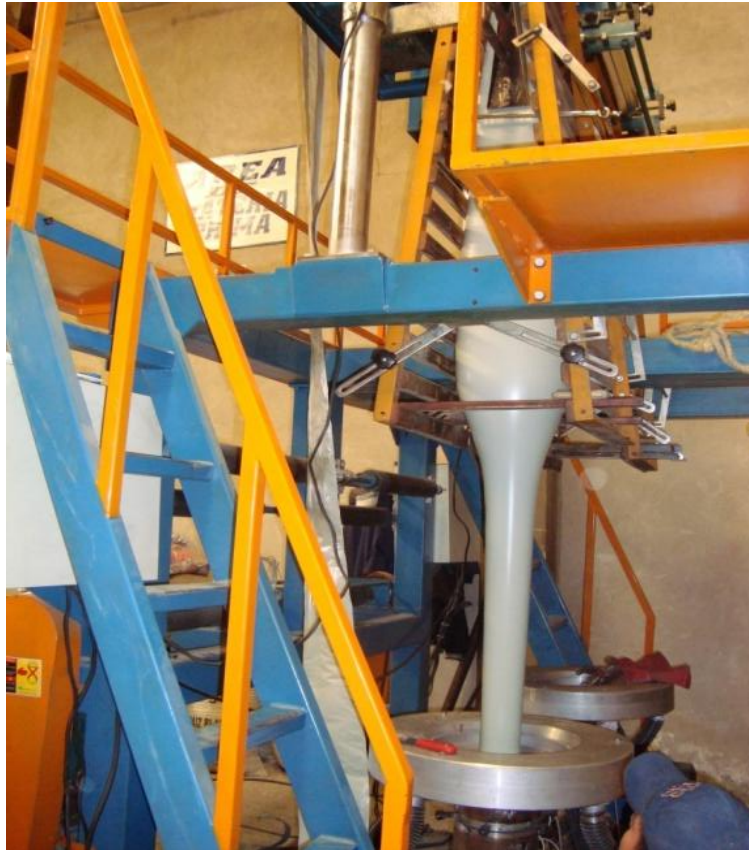
Imagen 4.4 extracción del globo a través de rodillo
