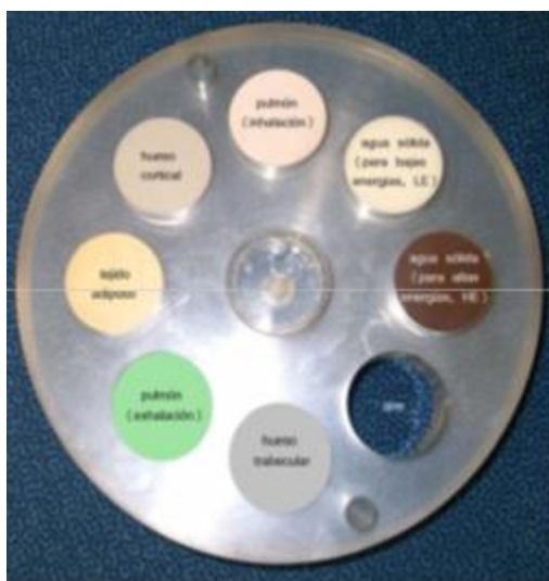
Figura 4.5. Maniquí utilizado para medir y obtener la distribución de dosis.
