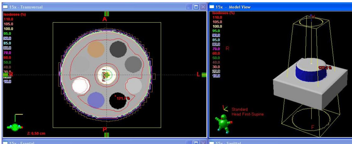
Figura 4.9. Distribución de la dosis en el maniquí virtual, con inserto central de cerrobend a 15MV. Toma transversal.
