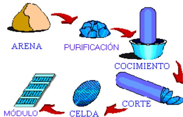
Figura 3-12. Proceso de fabricación de las celdas solares.
