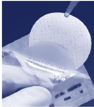
Figura 20. Filtro de membrana S- Pak ®, estériles y envasados individualmente.
