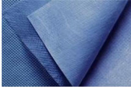
Figura 9. Polipropileno no tejido. Fabricado por Tecnología Regia en Equipo Médico e Industrial, S.A. DE C.V.
