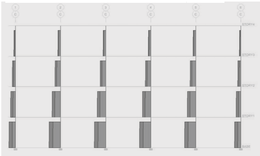
Ilustración 65 Diagrama de la envolvente de fuerzas axiales-Eje C
