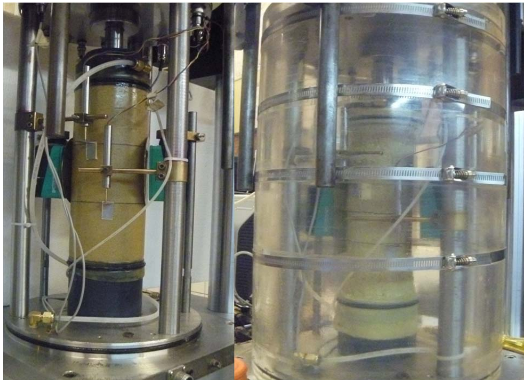
c) Colocación de sensores
