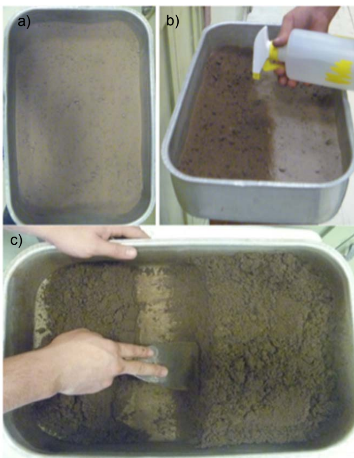
Figura 3.2 Proceso de preparación del material seco a parcialmente saturado, a) material seco, b) aplicación de agua controlada por peso, c) homogenización del material.
