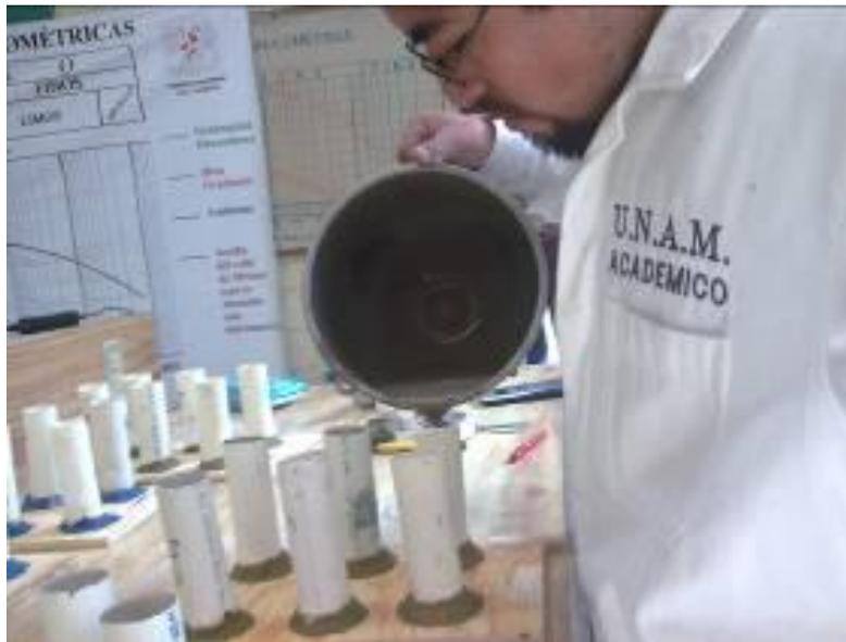
Figura 2.1.6. Llenado de probetas.
