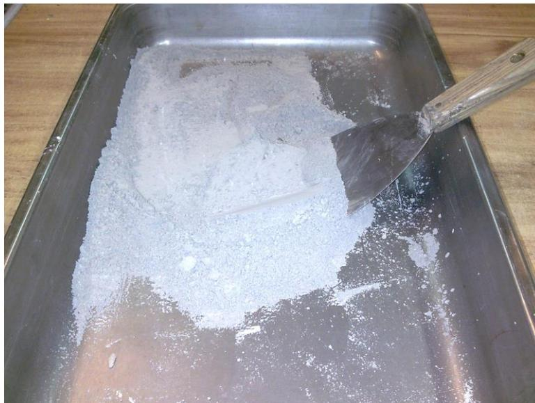
Figura 2.1.1. Mezclado de Bentonita cemento sin hidratación.
