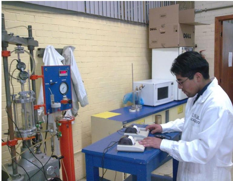
Figura 2.2.3. Prueba de compresión simple, registro de lecturas.
