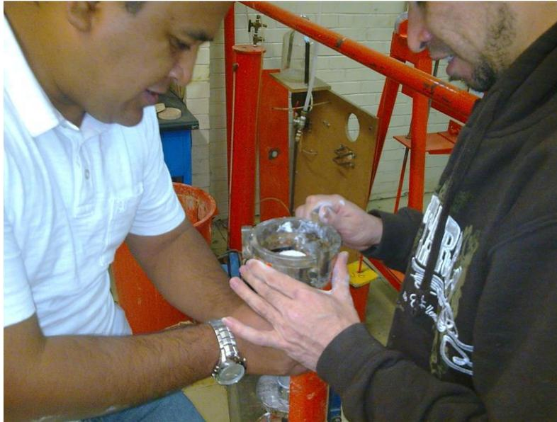
Figura 2.1.8 Extracción de la probeta del tubo PVC.
