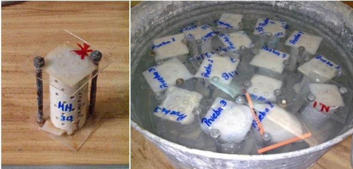
Figura 2.1.10. Muestras sumergidas en el agua.
