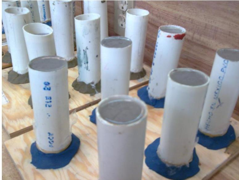
Figura 2.1.7. Probetas en proceso de fraguado.
