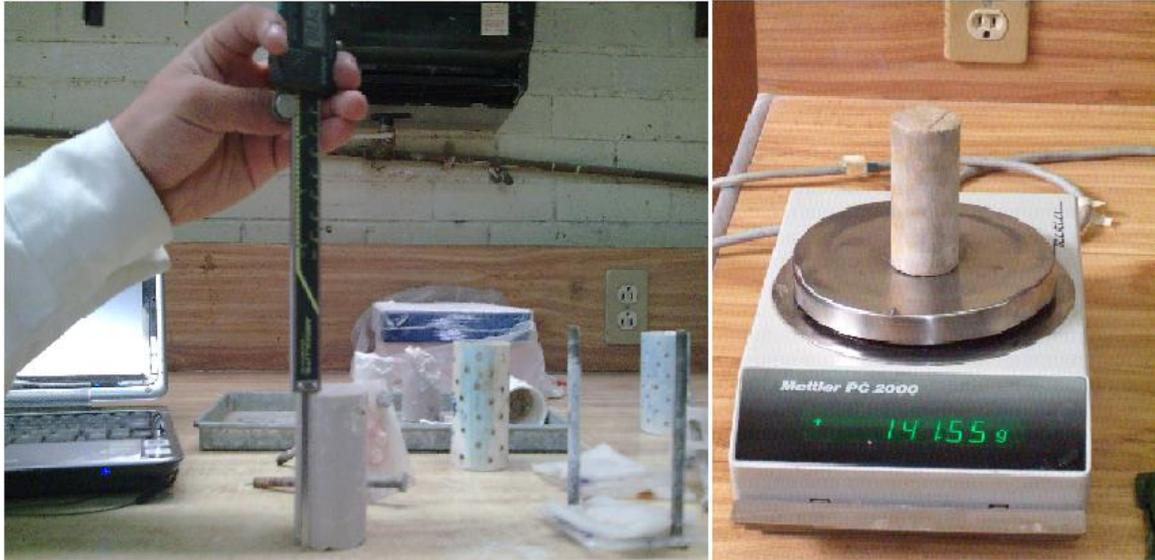
Figura 2.2.1. Medición del espécimen.
