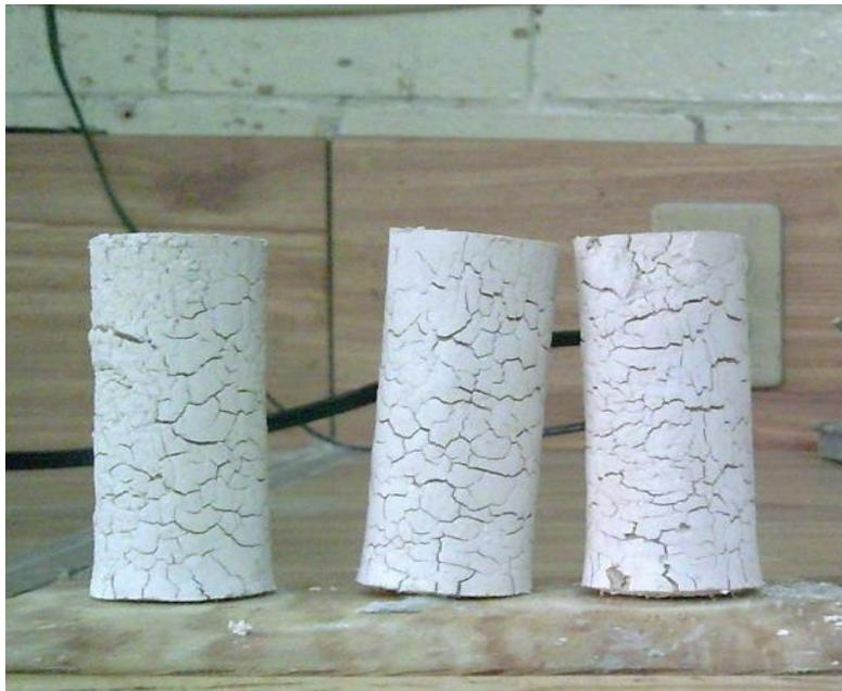
Figura 2.2.4. Probets fraguadas a la intemperie.
