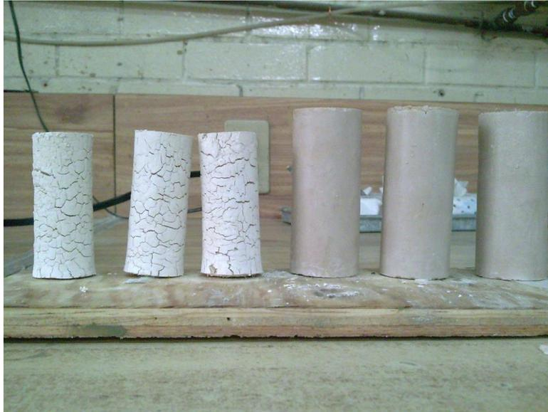
Fig. 3.1 Apariencia y contracción volumétrica de especímenes.
