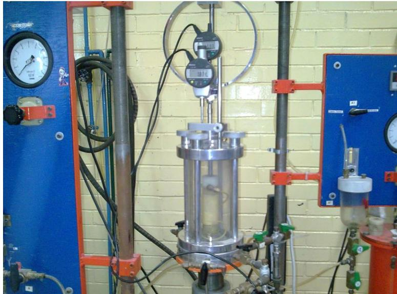
Figura 2.2.2. Ensayo de compresión simple.
