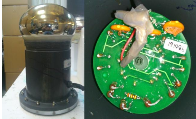
Figura 2. 20 Imágenes del PMT con su base de plástico y del circuito divisor de voltaje.
