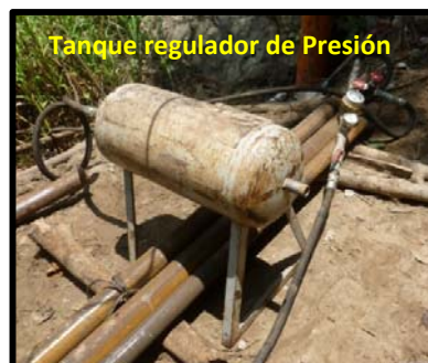
Fotografías 14 y 15. Equipo necesario para ejecutar las pruebas de permeabilidad.
