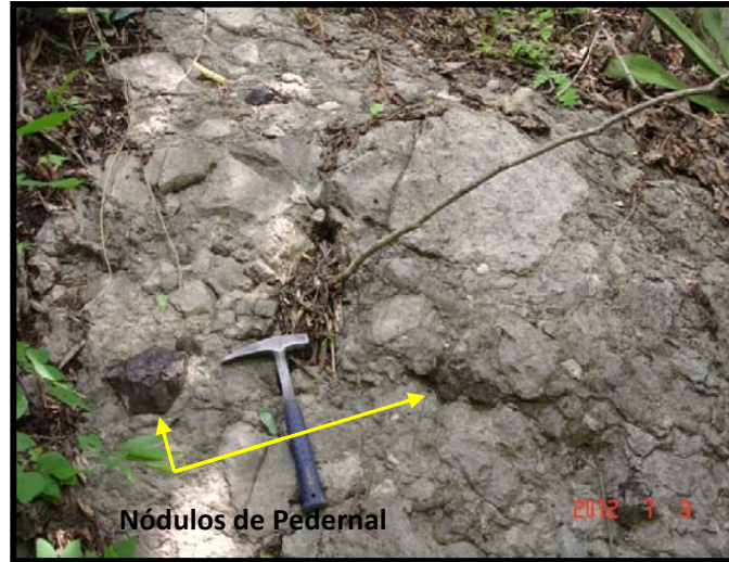
Fotografía 2. Detalle de la caliza brechoide, con bloques de caliza y nódulos de pedernal, margen derecha.
