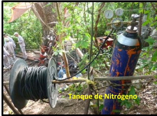
Fotografías 16 y 17. Equipo necesario para ejecutar las pruebas de permeabilidad.
