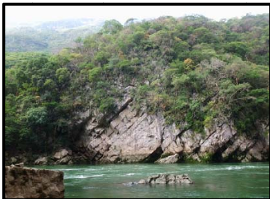
Fotografía 3. Estratificación en la caliza fosilífera. Margen izquierda, aguas abajo del sitio de cortina.
