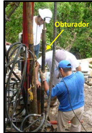
Fotografías 16 y 17. Equipo necesario para ejecutar las pruebas de permeabilidad.
