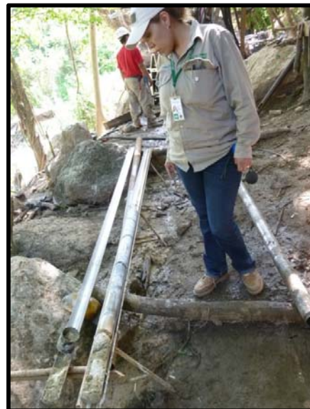
Fotografía 11. Recuperación de muestras para toma de recuperación R% y RQD%.
