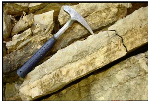
Fotografía 4. Estructura de estilolita paralela al plano de estratificación en la caliza fosilífera.
