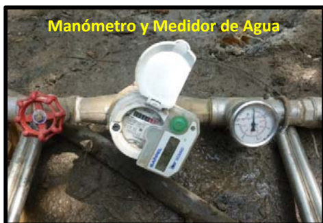
Fotografías 14 y 15. Equipo necesario para ejecutar las pruebas de permeabilidad.
