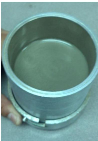
*Fig. 4.4 Celda del filtro prensa API*
