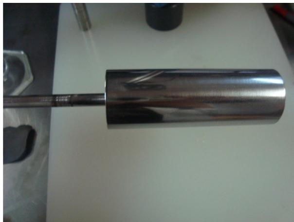
Figura 3. Electrodo cilíndrico rotatorio de acero inoxidable 316, antes de la electrorecuperación de cinc.
