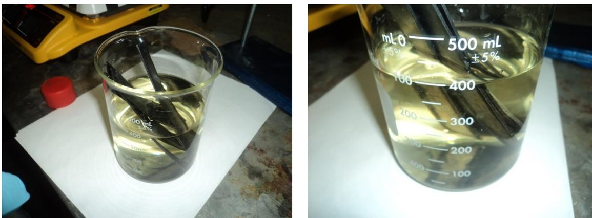
Figura 12. Placas de Titanio sumergidas en  $\text{HNO}_3$ . a) Placas de Titanio sumergidas en  $\text{HNO}_3$  al momento de ser sumergidas. b) Placas de Titanio sumergidas en  $\text{HNO}_3$  después de 5 min.
