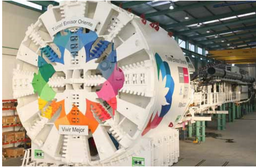
Figura B.1.14 Escudo de presión de tierras balanceadas (EPB) empleado para la construcción del Túnel Emisor Oriente en la ciudad de México
