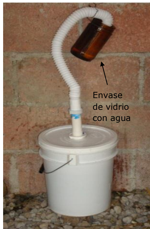
Figura 22. Envase o contenedor de la mezcla sellada y cerrada herméticamente con trampa de gases.
