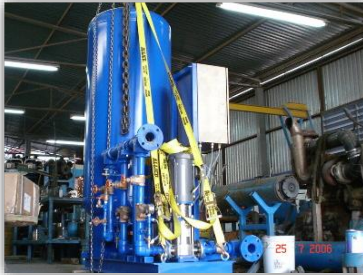
Figura 5. Paquete hidroneumático suministrado para plataforma marina de PEMEX. (Fuente: eqhisa.com.mx)
