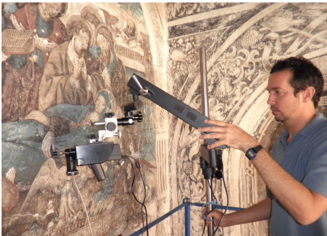
Imagen 5.6. Fotografía, análisis mediante espectroscopia Raman en Epazoyucan
