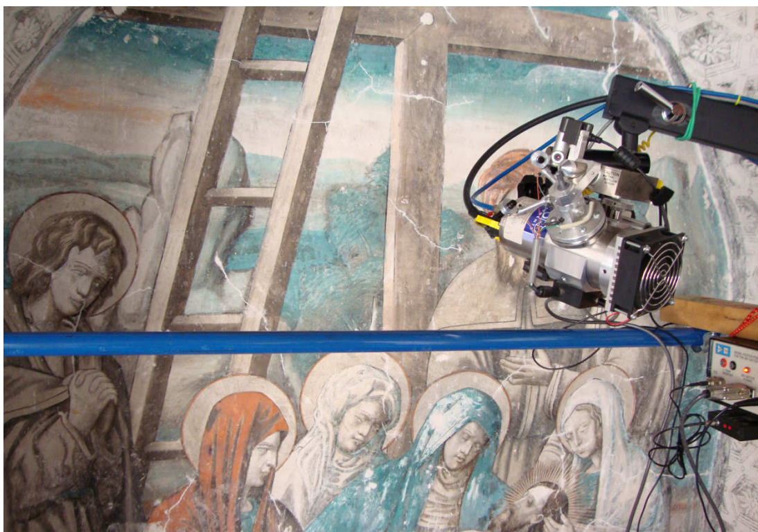
Imagen 5.4. Fotografía, análisis mediante fluorescencia de rayos X (FRX) en Epazoyucan
