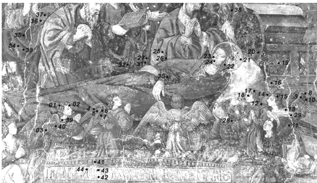
Detalle de puntos de análisis con FRX: Pintura Tránsito de la virgen María (Ep2)
