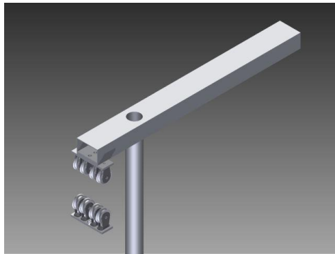
Figura 5.21 Polipasto montado en la columna principal
