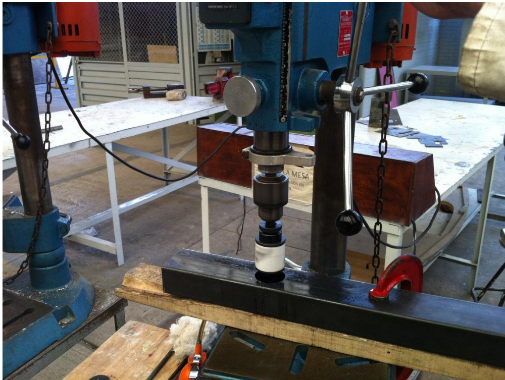
Figura 5.31 Manufactura del barreno con la broca sierra
