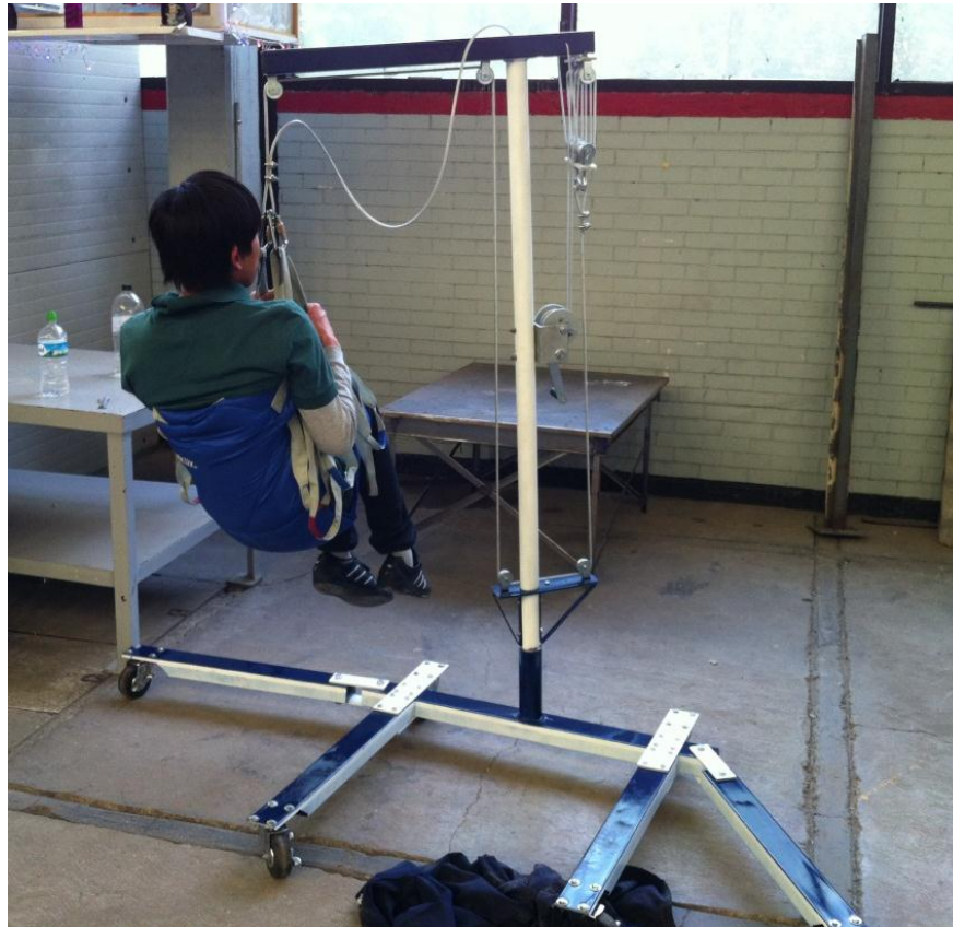
Figura 5.35 Dispositivo de traslado de pacientes terminado
