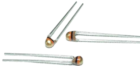
Figura 64. Termistores de 10 [K \Omega ] [82].
