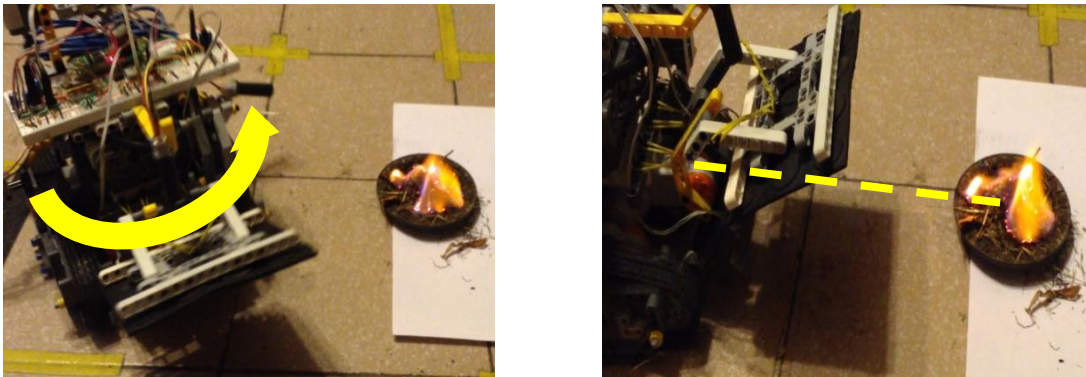
Figura 163. Izquierda, giro del modelo en la dirección del sensor PIR que detecta presencia de fuego. Derecha, coincidencia de la trayectoria de avance del modelo con la posición donde se encuentra la fuente de calor.
