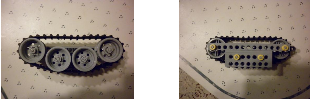
Figura 83. Propuesta para el uso de una oruga mono pieza, a la izquierda vista frontal y a la derecha vista trasera mostrando las vigas de apoyo para los rines.
