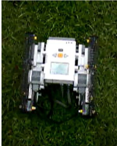
Figura 91. Prueba con el modelo para observar su desempeño al desplazarse sobre pasto.
