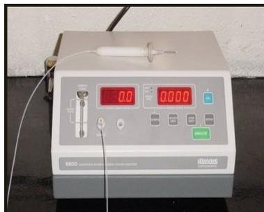
**Figura 5.** Analizador digital de gases de aire Illinois<sup>®</sup> modelo 6600.
