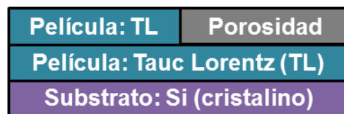
Figura 27. Esquema de capas utilizadas para el ajuste de los datos obtenidos por elipsometría espectroscópica para las películas de \delta -Bi 2 O 3 .
