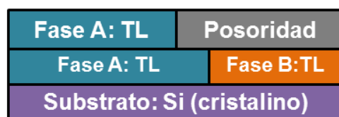
Figura 29. Esquema de capas utilizadas para el ajuste de los datos obtenidos por elipsometría espectroscópica para las películas que presentaron mezcla de fases.
