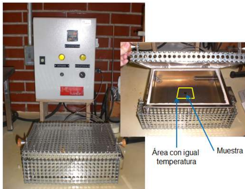
Figura 28. Horno eléctrico donde se realizaron los tratamientos térmicos de películas de \text{Bi}_2\text{O}_3 sobre sustratos de silicio y vidrio para su posterior caracterización.
