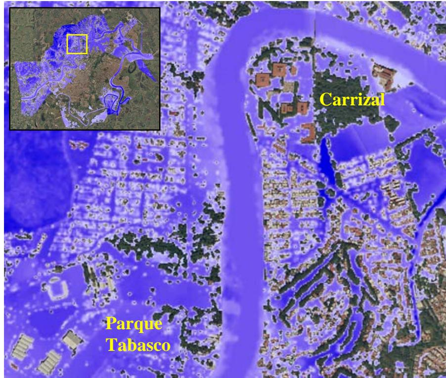
**Figura 3.17** Detalle de escenario de inundación para un periodo de retorno de  $T = 50$  años (colonia Carrizal y Parque Tabasco)
