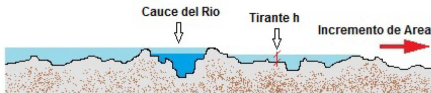
**Figura 3.21 Tirante de inundación constante e incremento del área de inundación en una sección tipo del río Carrizal**
