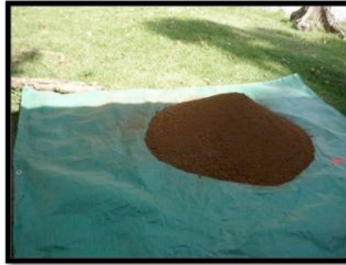
Figura 2.1 Homogenización de suelo sobre lona
