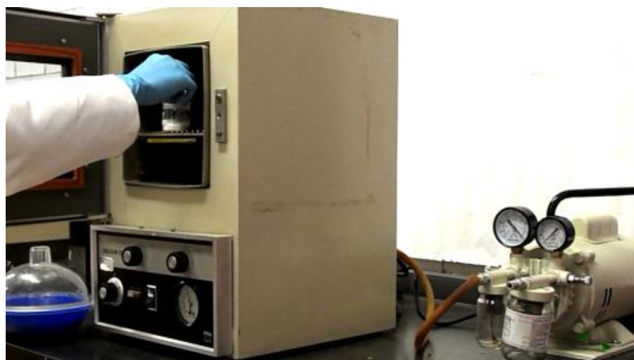
Fotografía 14. Estufa al vacío (obtención propia).
