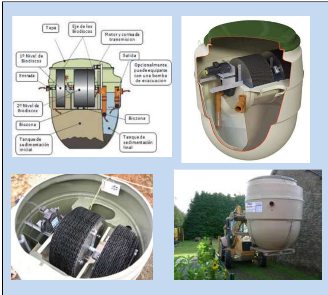
Figuras 3-4 a 3-7. PTAR compacta con sistema CBR incorporado en el mercado .Fuente: www.ambientum.com/revista/2002_05/BIODISCO1.asp
