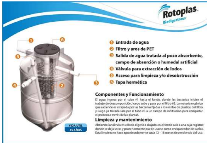
Figura 4-10. Elementos del biodigestor autolimpiable rotoplas. Fuente: www.rotoplas.com
